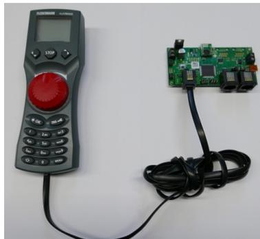
Die RF-Basis stellt dem Anwender ein Xpressnet Host zum Anschluss von Xpressnet Geräten zur Verfügung. Die mögliche Anzahl ist durch die 12V/500mA Stromversorgung des Xpressnet der RF-Basis auf ca. 5 Geräte begrenzt. Diese Versorgungsspannung ist dabei kurzschlussfest ausgeführt.
