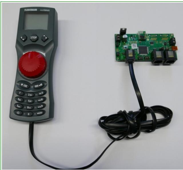
Die RF-Basis verfügt über einen Xpressnet Host Anschluss. Dieser ist für die Versorgung von Xpressnet Geräten mit insgesamt 500 mA Stromaufnahme ausgelegt. Dies reicht im Normalfall für 5 Handregler aus, die an der Xpressnet Buchse über handelsübliche Xpressnet Verteiler angeschlossen werden können. Wird der Bus auf der Anlage verlängert, eventuell mit externen Anschlussdosen, muss der Bus an der letzten Anschlussdose terminiert werden.
