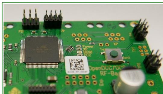
Im Bild sind dies (von links nach rechts) PDI Programmierport, Jumperblock, externer
