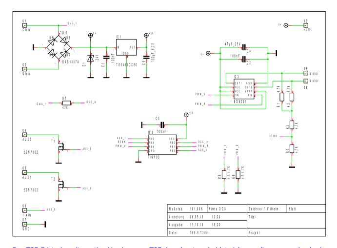
Der T85-5 ist eine alternative Version vom T85-4 und unterscheidet sich von diesem nur durch ein anderes Motorendstufen IC3. Der Widerstand R8 zur Motorstromeinstellung entfällt hier.
