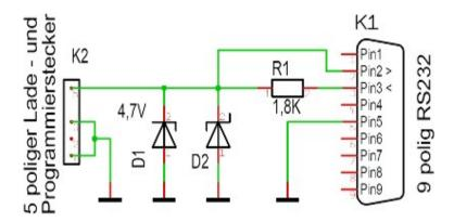
Sollte sich schon eine Betriebssoftware im DCC Decoder befinden, muss zuerst überprüft werden, ob in CV64 eine 1 steht. Wird jetzt ein Updatekabel gesteckt befindet sich der DCC Decoder nach einem Neustart im Bootloader Modus und wartet auf eine Verbindung zur Update Software "AVRootloader". Ohne Betriebssoftware geht der DCC Decoder immer in den Bootloader Modus. Folgende Verbindung muss jetzt zu einem PC hergestellt werden:
