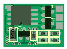
Die Mikrocontroller Seite der Platine ist bei beiden Decoder Varianten identisch. Oben links der Mikrocontroller ATtiny85, oben rechts die beiden Transistoren T1/2. Unten von links nach rechts der 100µF C5, der Spannungsregler IC1, C2 und die vier 4,7k Widerstände R1-4.
