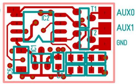
Gleis / Gleis → DCC Gleisanschlüsse Motor / Motor → Motoranschlüsse AUX0 / AUX1 → Funktionsanschlüsse
