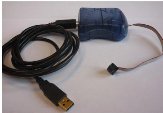
Die Firmware des IR – Sensors besteht nur aus dem „ir\_sense.hex“ File. Dieses steht als Download auf den Seiten des OpenCarSystem Projekt zur Verfügung und muss in den Programmspeicher des Attiny2313 geschrieben werden. Des weiteren müssen noch die „Optionsschalter“ → Fuse des ATtiny2313 richtig gesetzt werden:
