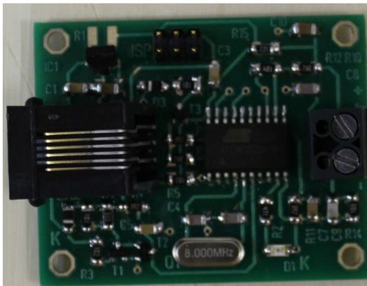
zum Schluss die restlichen Bauteile wie Spannungsregler, Quarz, RJ12 Buchse und Anschlussklemme
