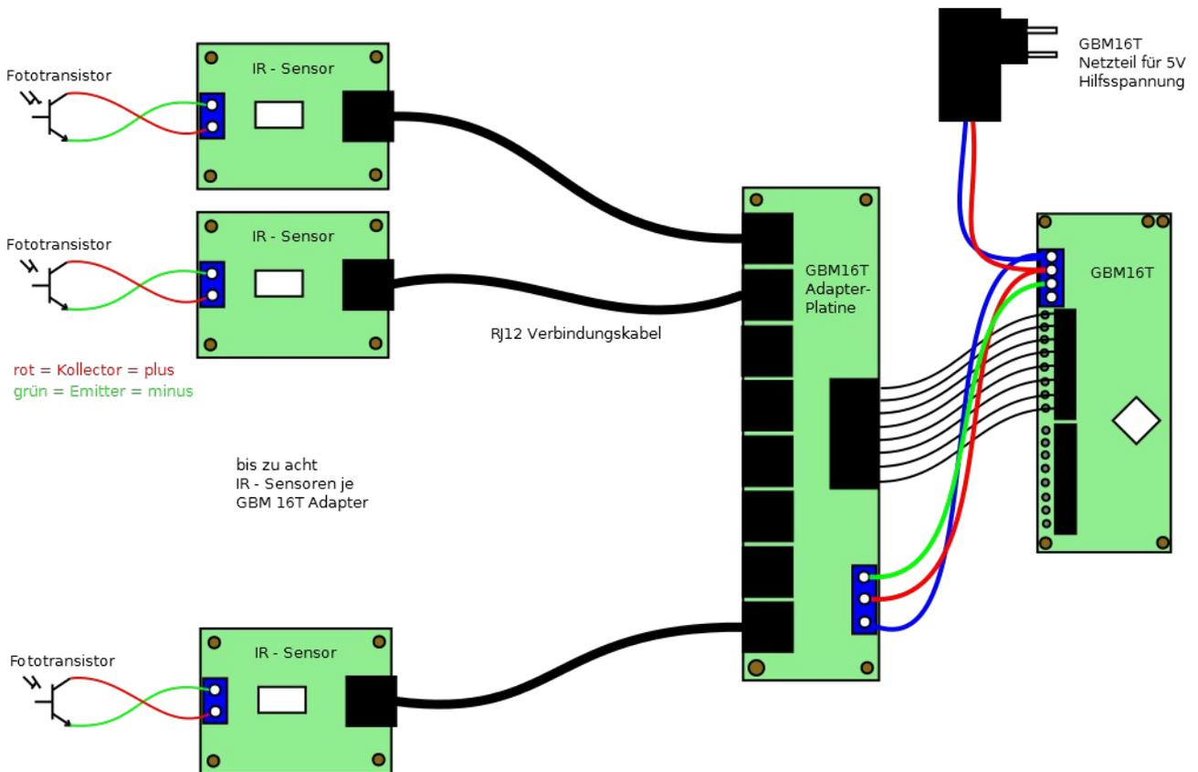
Die Adapterplatine wird mit dem GBM16T mit einer drei poligen Verbindung und den acht Sensorleitungen verbunden. Dabei ist blau und rot im Anschlussplan die 5V Hilfsspannung am GBM16T und grün ist die DCC\_1 Leitung. Die acht Sensorausgänge werden mit acht DCC\_2 Eingängen auf dem GBM16T verbunden.
