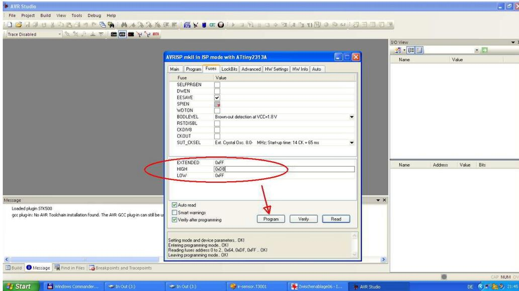
Es bleibt jetzt noch die eigentliche Firmware des IR – Sensors, diese im Reiter „Programm“ unter Flash auswählen und dann auf den Tunny2313 programmieren:
