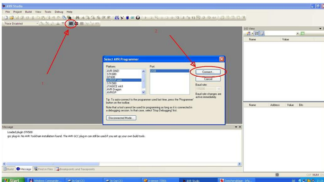
Im „Programmierdialog“ zuerst den Tiny2313A auswählen und Anhand der Signatur die Verbindung zu diesem überprüfen:
